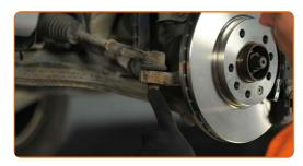
8 Svitare il dado di attacco del gambo al fuso a snodo. Utilizza una chiave a bussola N°18. Usa una chiave a cricchetto.
