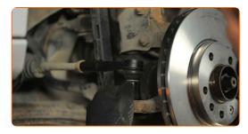
Serra il bullone di fissaggio che collega la testina tirante al fuso a snodo. Utilizza una chiave a bussola N°18. Usa una chiave dinamometrica. Serralo fino allo coppia di torsione di 30 Nm. +90°
