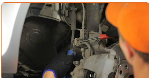
**7** Scollega il connettore del sensore di velocità ABS. Usa un giravite piatto.
