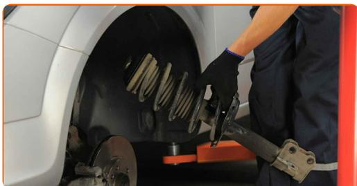
**20** Montare il supporto di ammortizzazione sul dispositivo speciale per la compressione delle molle.
