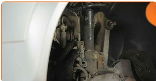
**43** Fissare sul montante il tubo dell'impianto freni.
