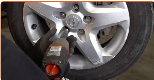
Sostituzione: dischi freni - OPEL ASTRA H Furgonato (L70). AUTODOC raccomanda:
