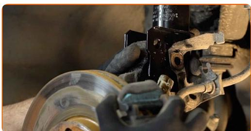
**33** Fissare sul montante il tubo dell'impianto freni.
