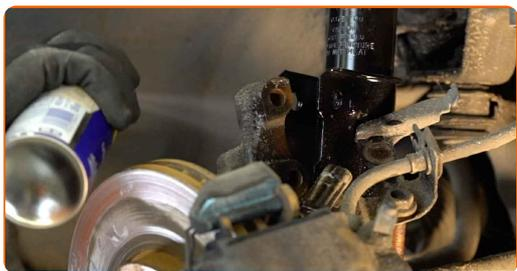
**32** Fissare il supporto di ammortizzazione sul fuso a snodo.
