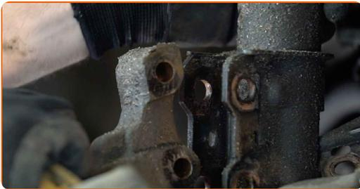
**15** Svitare il perno di fissaggio superiore del supporto di ammortizzazione. Utilizza una chiave combinata N°19. Utilizza una chiave a bussola N°9. Usa una chiave a cricchetto.
