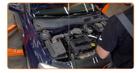
Avvitare le nuove candele e serrarle. Usa la chiave a bussola per candele numero 16. Usa una chiave dinamometrica. Serralo fino allo coppia di torsione di 24 Nm.
