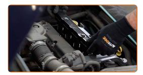
Stringere gli elementi di fissaggio della bobina di accensione. Usa la chiave Torx T30. Usa una chiave dinamometrica. Serralo fino allo coppia di torsione di 15 Nm.
