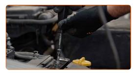
Tratta il connettore delle bobine di accensione con uno spray per dispositivi elettronici. Lo spray proteggerà i contatti elettrici dalla corrosione, l'ossidazione e la resistenza di contatto.
