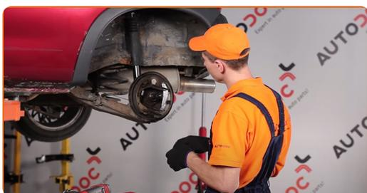
**16** Installare il nuovo cilindro del freno.
