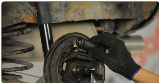
**17** Avvitare l'elemento di fissaggio del cilindretto. Utilizza una chiave a bussola N°10. Usa una chiave dinamometrica. Serralo fino allo coppia di torsione di 10 Nm.
