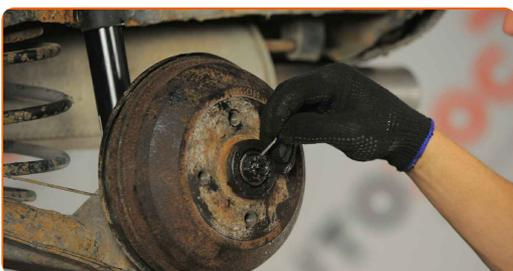
**25** Installare il cappuccio di protezione del cuscinetto del mozzo. Usa un martello di gomma.
