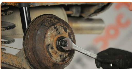
**24** Installare la copiglia del dado di fissaggio cuscinetto mozzo ruota. Usa delle pinze a becchi lunghi.
