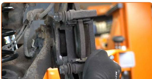
**15** Pulisci gli elementi di fissaggio del disco freno. Usa una spazzola metallica. Usa lo spray WD-40.
