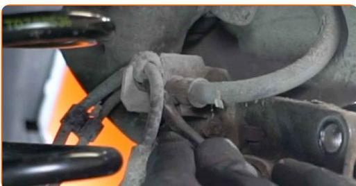
**19** Scollega il connettore del sensore di velocità ABS. Usa un piede di porco.
