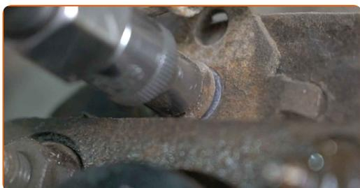
**23** Rimuovere la staffa supporto del cablaggio ABS.
