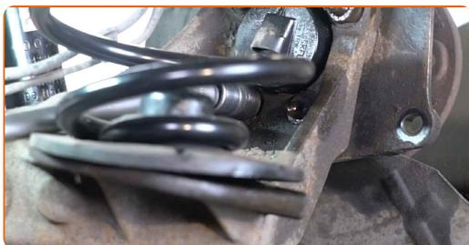
**22** Svitare gli elementi di fissaggio del supporto del cablaggio ABS. Utilizza una chiave a bussola N°E8. Usa una chiave a cricchetto.
