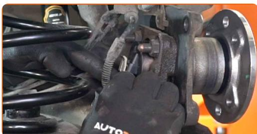
**34** Installare la staffa supporto del cablaggio ABS.
