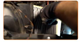
Pulisci il coperchio del filtro dell'aria e l'alloggiamento.
