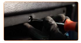
Rimuovi la copertura di protezione del parafango.
