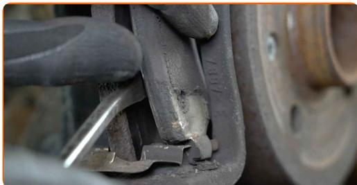
**12** Pulisci gli elementi di fissaggio del supporto pinza freno. Usa una spazzola metallica. Usa un pulitore freni.
