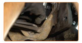
Installare la staffa di fissaggio del tubo flessibile del freno e del cavo ABS. Utilizza una chiave a bussola N°E8. Usa una chiave a cricchetto.
