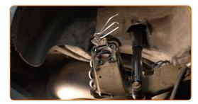
Rimuovi la lamiera di protezione del disco freno.
