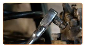
Collega il tubo flessibile del kit di spurgo freno pneumatico alla valvola di spurgo del freno.
