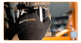
Montare la pinza del freno e fissarla.
