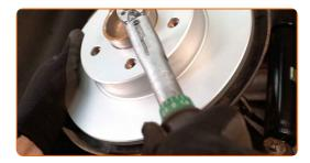
Installare il sostegno pinza freno.
