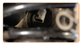
Pulisci gli elementi di fissaggio del cuscinetto del mozzo ruota. Usa una spazzola metallica. Usa lo spray WD-40.
