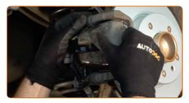
Serra gli elementi di fissaggio della pinza del freno. Utilizza una chiave combinata N°17. Utilizza una chiave a bussola N°13. Usa una chiave dinamometrica. Serralo fino allo coppia di torsione di 25 Nm.
