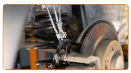
Svitare il tubo flessibile del freno dalla pinza del freno. Utilizza una chiave combinata N°11.
