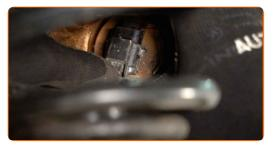
Collegare il cablaggio del sensore ABS.
