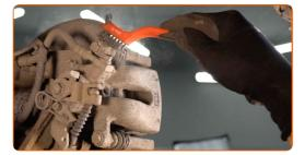
Pulisci l'area nella quale il tubo del freno è connesso alla pinza, e la zona dei perni guida. Usa una spazzola metallica. Usa un pulitore freni.
