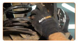
Serrare gli elementi di fissaggio del cuscinetto mozzo ruota. Utilizza una chiave a bussola N°16. Usa una chiave a cricchetto.
