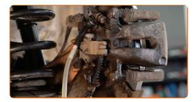
Spurgare la pinza del freno. Senza avviare il motore, premere il pedale del freno più volte finché non viene percepita una resistenza significativa.
