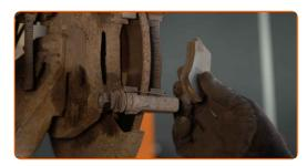
Pulisci gli elementi di fissaggio del supporto pinza freno. Usa una spazzola metallica. Usa un pulitore freni.
