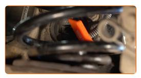
Scollega il connettore del sensore di velocità ABS. Usa un piede di porco.
