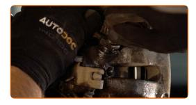
Serra gli elementi di fissaggio del tubo flessibile del freno. Utilizza una chiave a bussola N°11. Usa una chiave dinamometrica. Serralo fino allo coppia di torsione di 40 Nm.
