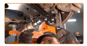
Stringi gli elementi di fissaggio del giunto sferico. Utilizza una chiave a bussola N°19. Utilizza una chiave combinata N°17. Usa una chiave dinamometrica. Serralo fino allo coppia di torsione di 50 Nm.
