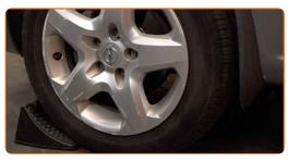
Allentare i bulloni di fissaggio della ruota. Usa la chiave a bussola per dadi cerchio ruota n.17.
