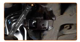
Serra gli elementi di fissaggio posteriori del braccio di controllo. Utilizza una chiave combinata N°18. Utilizza una chiave a bussola N°18. Usa una chiave dinamometrica. Serralo fino allo coppia di torsione di 90 Nm. +90°
