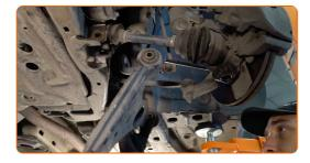
Pulisci le sedi di montaggio e la filettatura del braccio di sospensione. Usa una spazzola metallica. Usa lo spray WD-40.
