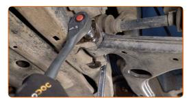
Allenta l'elemento di fissaggio posteriore del braccio di sospensione. Utilizza una chiave a bussola N°18. Utilizza una chiave combinata N°18. Usa una chiave a cricchetto.
