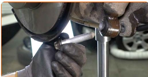
**10** Svita l'elemento di fissaggio superiore dell'ammortizzatore. Utilizza una chiave a bussola N°E18. Usa un giramaschi.
