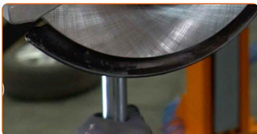
**19** Stringi l'elemento di fissaggio inferiore dell'ammortizzatore. Utilizza una chiave a bussola N°E20. Usa una chiave dinamometrica. Serralo fino allo coppia di torsione di 130 Nm.
