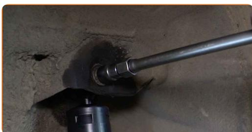
**21** Rimuovi il supporto da sotto la trave dell'asse posteriore.
