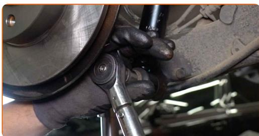
**20** Serrare il perno di fissaggio superiore dell'ammortizzatore. Utilizza una chiave a bussola N°E18. Usa una chiave dinamometrica. Serralo fino allo coppia di torsione di 90 Nm.
