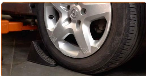
**3** Allentare i bulloni di fissaggio della ruota. Usa la chiave a bussola per dadi cerchio ruota n.17.
