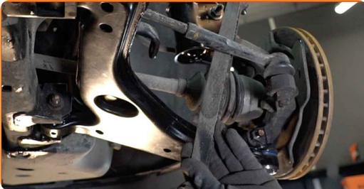
**11.1** Installare una nuova barra, serrarne gli elementi di montaggio.
