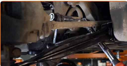
**11.2** Utilizza una chiave combinata N°19. Utilizza una chiave a bussola N°18. Usa una chiave dinamometrica. Serralo fino alla coppia di torsione di 65 Nm.
