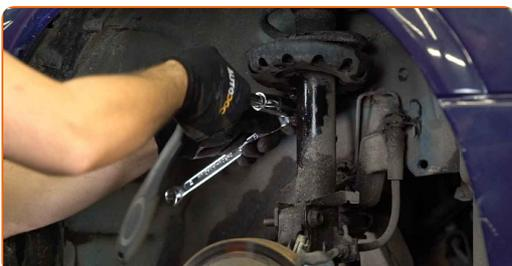
**8** Pulisci gli elementi di fissaggio dei tiranti delle barre stabilizzatrici. Usa una spazzola metallica. Usa lo spray WD-40.
