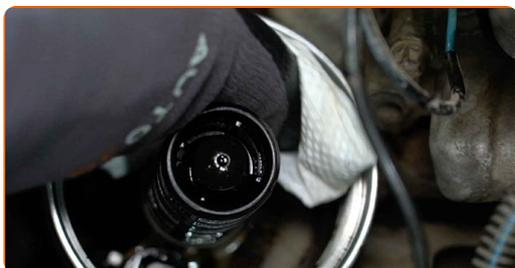
**24** Installare il coperchio dell'alloggiamento del filtro dell'olio ed avvitarlo. Utilizza una chiave a bussola N°32. Usa una chiave dinamometrica. Serralo fino allo coppia di torsione di 15 Nm.
