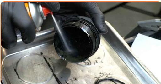
**23** Installa il nuovo coperchio O-ring sulla sua sede di montaggio sul coperchio del filtro.
