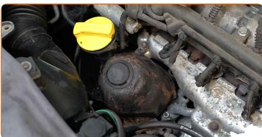
**29** Avvita gli elementi di fissaggio della custodia protettiva della scatola del filtro dell'olio. Usa la chiave Torx T25. Utilizza una chiave a bussola N°10. Usa una chiave a cricchetto.
