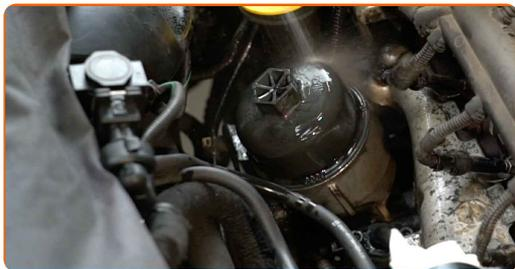
**17** Svitare il tappo dell'alloggiamento del filtro insieme al vecchio elemento filtrante. Utilizza una chiave a bussola N°27. Usa una chiave a cricchetto.
