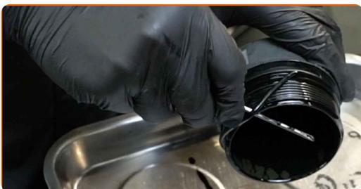
**22** Pulisci il tappo dell'alloggiamento del filtro dell'olio. Usa un detergente spray multiuso.
