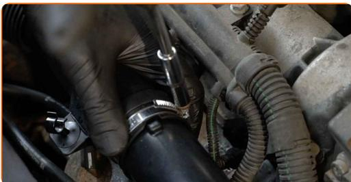
**37** Avvita l'elemento di fissaggio del tubo della presa d'aria. Usa la chiave Torx T25.
