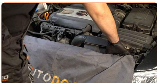
**3** Rimuovere la copertura del motore.
