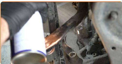
**12** Svitare l'attacco della staffa pinza freno. Usa la chiave XZN n.14. Usa un giramaschi. Usa una chiave a cricchetto.
