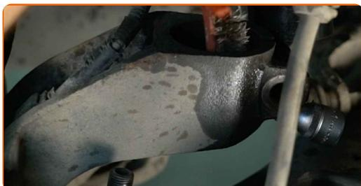
**43** Fissare il supporto di ammortizzazione sul fuso a snodo.
