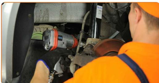
**48** Installa il puntone stabilizzatore trasversale.
