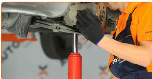
**45** Monta il bullone di fissaggio. Usa un martello.
