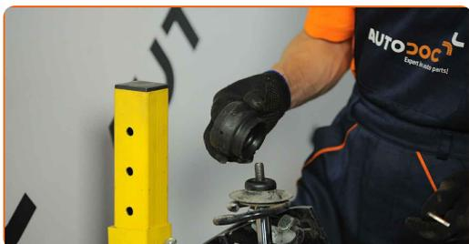
**32** Serrare la vite dell'asta pistone supporto ammortizzazione. Utilizza una chiave a bussola N°20.6. Usa una chiave HEX N.H6. Usa una chiave dinamometrica. Serralo fino allo coppia di torsione di 60 Nm.
