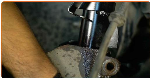
**44** Puntellare il fuso a snodo. Usa un cric idraulico per trasmissione.
