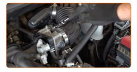
Scollega il tubo di aspirazione dell'aria dall'alloggiamento del filtro dell'aria.
