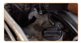
Collega l'amplificatore del tubo per il vuoto al collettore di aspirazione. 27
