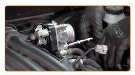
Collega il connettore e il tubo per il vuoto al collettore di aspirazione vicino alla valvola a farfalla. Usa delle pinze a becchi lunghi.
