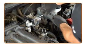
Scollega il morsetto e rimuovi il connettore e il tubo per il vuoto dal collettore di aspirazione vicino alla valvola a farfalla. Usa delle pinze a becchi lunghi.
