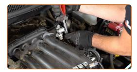
Svita gli elementi di fissaggio della staffa di supporto del collettore di aspirazione. Utilizza una chiave a bussola N°10.
