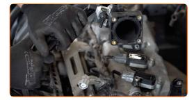
Serra gli elementi di fissaggio del collettore di aspirazione. Utilizza una chiave a bussola N°10. Usa una chiave dinamometrica. Serralo fino allo coppia di torsione di 27 Nm.
