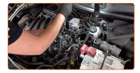
Connetti il tubo flessibile del sistema di ventilazione del basamento al condotto dell'aria. Usa delle pinze a becchi lunghi.
