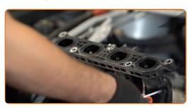
Rimuovi la guarnizione del collettore di aspirazione. Usa un giravite piatto.
