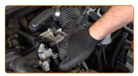
Svita il morsetto e gli elementi di fissaggio del tubo di aspirazione del filtro dell'aria. Utilizza una chiave a bussola N°10. Usa una chiave a cricchetto.
