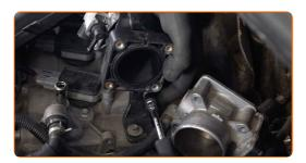
Scollega l'amplificatore del tubo per il vuoto dal collettore di aspirazione.
