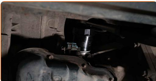
14 Rimuovere il filtro dell'olio. Prepara un contenitore per il filtro dell'olio vecchio. Metti il vecchio filtro dell'olio nel contenitore.
