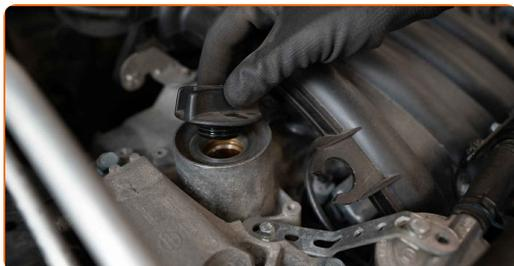
**3** Versa il fluido detergente per il motore.
