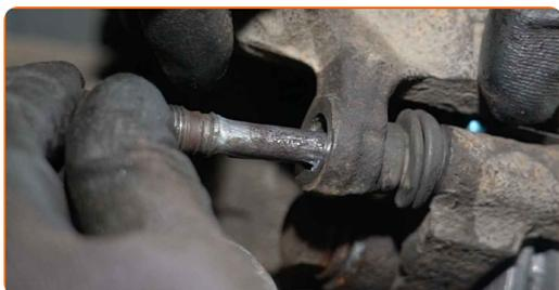
**21** Serra gli elementi di fissaggio della pinza del freno. Utilizza una chiave a bussola N°14. Usa una chiave dinamometrica. Serralo fino allo coppia di torsione di 32 Nm.
