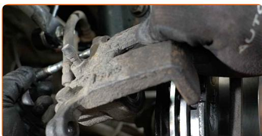
**20** Installare i perni di guida della pinza del freno.
