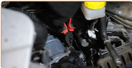
**24** Serra i morsetti di fissaggio dei tubi del filtro carburante. Usa delle pinze.
