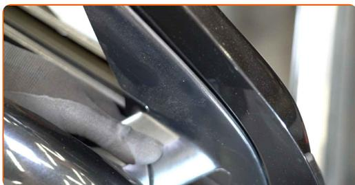
**12** Avvitare gli elementi di fissaggio dello specchietto laterale. Utilizza una chiave a bussola N°10. Usa una chiave a cricchetto.
