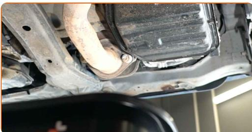
**7** Pulisci la zona del foro di drenaggio della coppa dell'olio. Usa una spazzola metallica. Usa un detergente spray multiuso.
