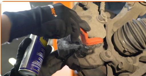
**9** Svitare l'attacco della pinza freno. Utilizza una chiave combinata N°17. Utilizza una chiave a bussola N°14. Usa una chiave a cricchetto.
