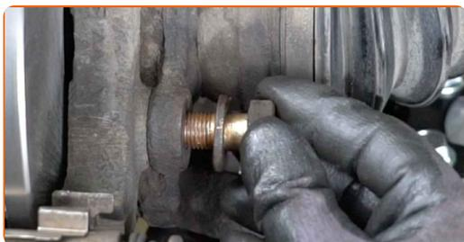
**25** Serrare gli elementi di fissaggio del supporto della pinza del freno. Utilizza una chiave a bussola N°22. Usa una chiave dinamometrica. Serralo fino allo coppia di torsione di 148 Nm.
