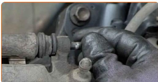
**33** Serra gli elementi di fissaggio della pinza del freno. Utilizza una chiave a bussola N°14. Usa una chiave dinamometrica. Serralo fino alla coppia di torsione di 32 Nm.
