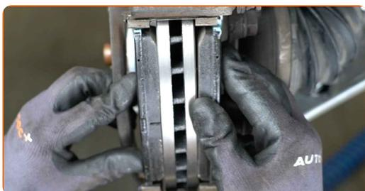
**30** Montare la pinza del freno e fissarla.
