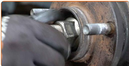
**69** Serrare l'elemento di fissaggio che collega il giunto sferico al fuso a snodo dello sterzo. Utilizza una chiave combinata N°22. Usa una chiave dinamometrica. Serralo fino allo coppia di torsione di 77 Nm.
