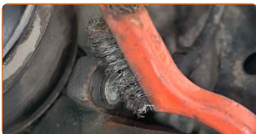
**19** Svita gli elementi di fissaggio del sensore ABS. Utilizza una chiave a bussola N°10. Usa una chiave a cricchetto.
