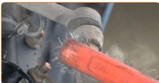
**23** Svitare il dado di attacco del gambo al fuso a snodo. Utilizza una chiave a bussola N°22. Usa una chiave a cricchetto.
