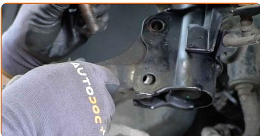
**45** Rimuovere il fuso a snodo dello sterzo insieme al mozzo della ruota.
