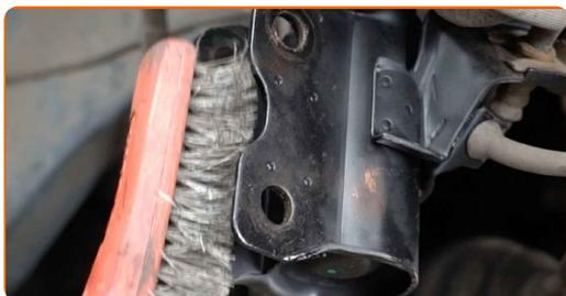
**60** Pulisci le scanalature del giunto omocinetico dell'albero di trasmissione. Usa una spazzola metallica. Usa lo spray WD-40.
