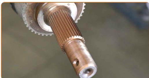
**62** Pulisci l'elemento di fissaggio che collega il giunto sferico al fuso a snodo. Usa una spazzola metallica. Usa lo spray WD-40.
