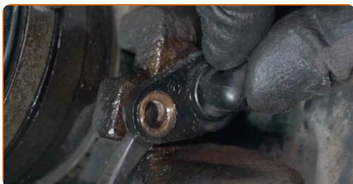
**22** Pulisci l'elemento di fissaggio che collega le testine tiranti al fuso a snodo. Usa una spazzola metallica. Usa lo spray WD-40.
