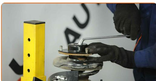
Sostituzione: supporto ammortizzatore - NISSAN PRIMERA Hatchback (P12). Il consiglio di AUTODOC:
