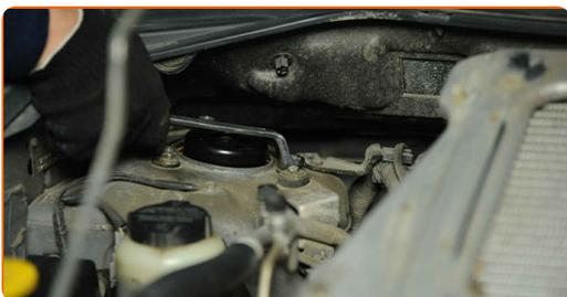
**28** Tratta con del prodotto gli elementi di fissaggio del supporto del puntone dell'ammortizzatore. Usa il grasso al rame.
