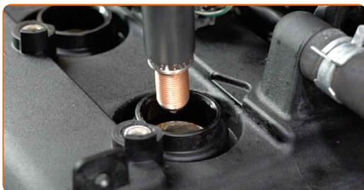
Sostituzione: candele di accensione - NISSAN PRIMERA Hatchback (P12).
