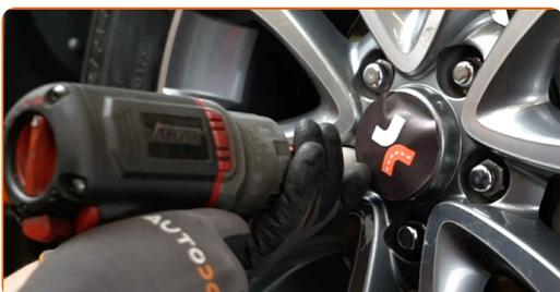
**22** Rimettere il veicolo per terra e, lavorando in ordine incrociato, serrare i bulloni di fissaggio delle ruote. Usa la chiave a bussola per dadi cerchio ruota n.21. Usa una chiave dinamometrica. Serralo fino allo coppia di torsione di 118 Nm.
