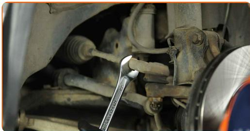
**8** Rimuovere il semicono che fissa il perno di montaggio della testa barra comando sterzo. Usa delle tenaglie.
