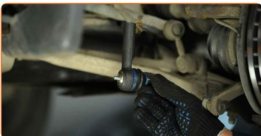
Sostituzione: testine sterzo - NISSAN PICK UP (D22). Gli esperti di AUTODOC raccomandano:
