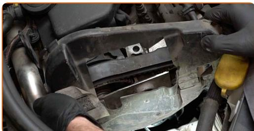
**79** Installare la parte superiore del supporto del motore.
