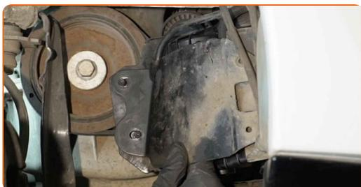
**102** Avvitare i bulloni di fissaggio della staffa del filtro carburante. Utilizza una chiave a bussola N°13. Usa una chiave a cricchetto.
