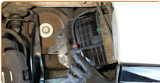
**100** Avvitare i bulloni di fissaggio della staffa del filtro carburante. Utilizza una chiave combinata N°10.
