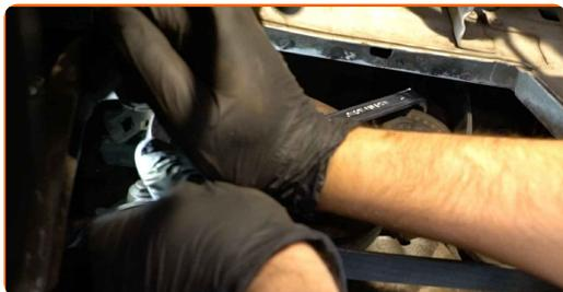
**96** Avvitare gli elementi di fissaggio del sottotelaio. Utilizza una chiave a bussola N°18. Usa una chiave a cricchetto.
