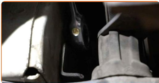
**15** Rimuovere la staffa di fissaggio del filtro carburante.
