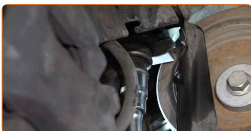
**99** Installare la staffa di fissaggio del filtro carburante.
