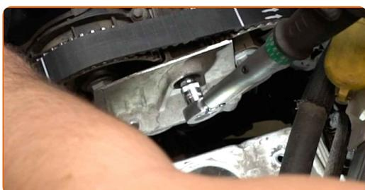
**78** Installare il carter di distribuzione superiore. Assicurati di sentire un clic indicante che si trova installato saldamente.
