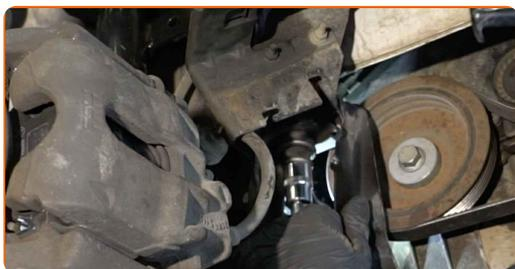
**97** Stringere gli elementi di fissaggio della staffa di rinforzo del sottotelaio. Utilizza una chiave a bussola N°13. Usa una chiave dinamometrica. Serralo fino allo coppia di torsione di 35 Nm.
