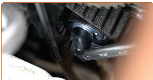
**71** Rimuovere lo strumento di bloccaggio dell'ingranaggio dell'albero a camme.
