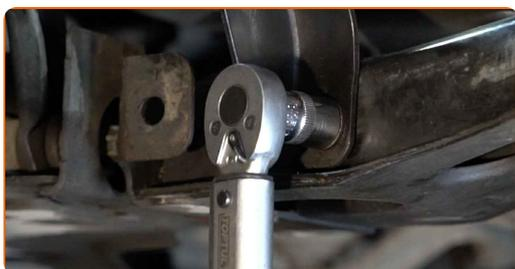
**98** Serrare il perno di fissaggio del telaio di base. Utilizza una chiave a bussola N°18. Usa una chiave dinamometrica. Serralo fino allo coppia di torsione di 105 Nm.
