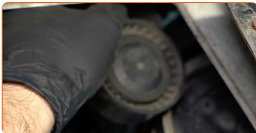
**86** Stringere il dispositivo di fissaggio del rullo tenditore della cinghia Poly-V. Utilizza una chiave a bussola N°13. Usa una chiave dinamometrica. Serralo fino alla coppia di torsione di 35 Nm.
