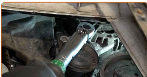
**87** Svitare il dispositivo di fissaggio della puleggia dell'albero a gomiti. Utilizza una chiave a bussola N°18. Usa una chiave a cricchetto.
