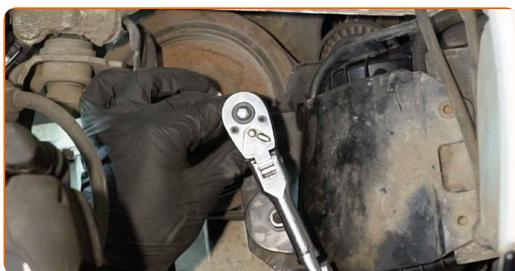
**103** Installa i parasassi del passaruota alla loro sede di montaggio.
