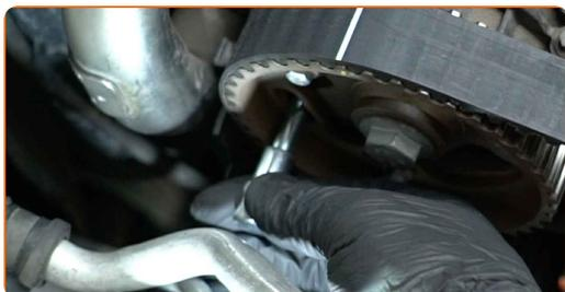
**72** Rimuovere lo strumento di bloccaggio dell'ingranaggio dell'albero a gomiti.
