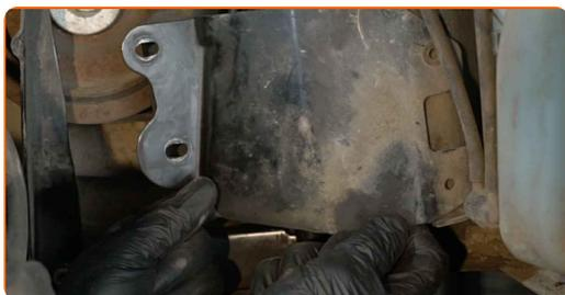
**14** Svitare i bulloni della staffa di fissaggio del filtro carburante. Utilizza una chiave combinata N°10.
