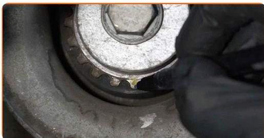
**40** Installare lo strumento di bloccaggio dell'ingranaggio dell'albero a camme secondo le indicazioni del produttore. Usare un kit attrezzi fasatura motore.
