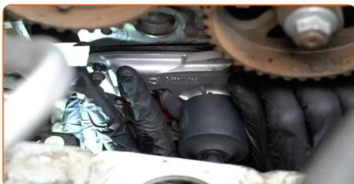
**63** Stringere i dispositivi di fissaggio della pompa dell'acqua. Utilizza una chiave a bussola N°8. Usa una chiave dinamometrica. Serralo fino allo coppia di torsione di 12 Nm.
