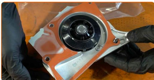
**62** Installare la nuova pompa dell'acqua.
