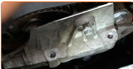
**77** Serra i bulloni di fissaggio del supporto del motore. Utilizza una chiave a bussola N°10. Usa una chiave dinamometrica. Serralo fino allo coppia di torsione di 40 Nm.
