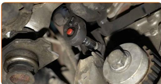
**48** Svitare il dispositivo di fissaggio del rullo tenditore della cinghia Poly-V. Utilizza una chiave combinata N°13.
