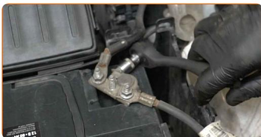
**4** Rimuovi i terminali della batteria.
