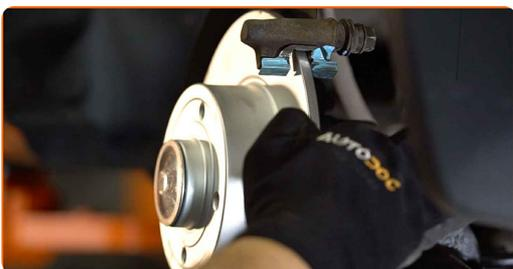
**14** Premere il pistone della pinza freno. Usa un arretratore per pistoncini freni a disco.
