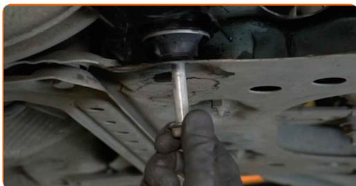
**18** Collegare il giunto sferico al fuso a snodo dello sterzo.
