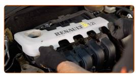
Rimuovi ilcavi connettori della candela dai loro fori. Usa delle pinze a becchi lunghi.
