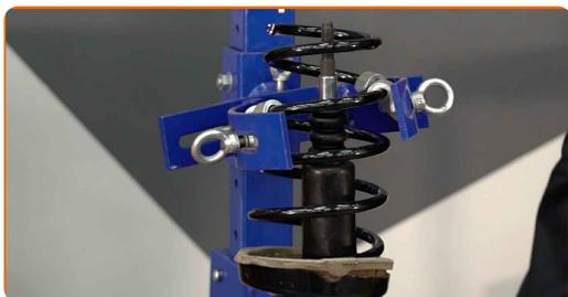
**26** Installare l'elemento di montaggio del supporto di ammortizzazione superiore.
