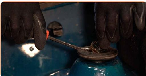
**4** Allenta gli elementi di fissaggio superiori del supporto dell'ammortizzatore. Utilizza una chiave combinata N°21. Usa una chiave HEX N.H6. Usa una chiave a cricchetto.
