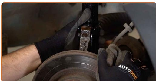
**34** Rimuovi il supporto da sotto il fuso a snodo.
