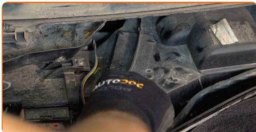
**12** Avvita gli elementi di fissaggio del coperchio del filtro abitacolo. Usa un cacciavite Phillips.
