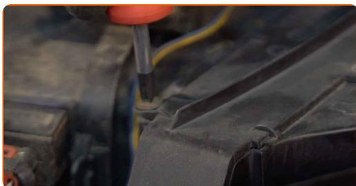
**13** Installa la griglia del sottoparabrezza e fissala.
