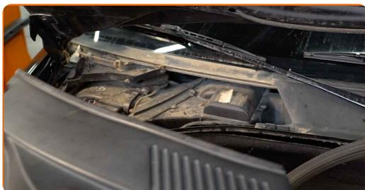
**6** Pulisci l'alloggiamento e il coperchio del filtro abitacolo. Usa un detergente spray multiuso.
