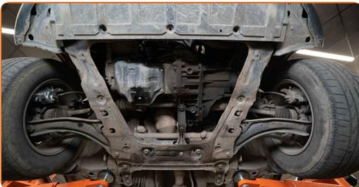
9 Poni un contenitore per gli oli esausti di una capacità di almeno 5 litri al di sotto del foro di drenaggio.
