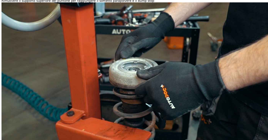
Fai attenzione! • Il bump stop può essere installato sull'asta del pistone o fissato al supporto • Il soffietto parapolvere può essere montato sul bump stop, installato tra la molla e il supporto, o fissato al supporto.
