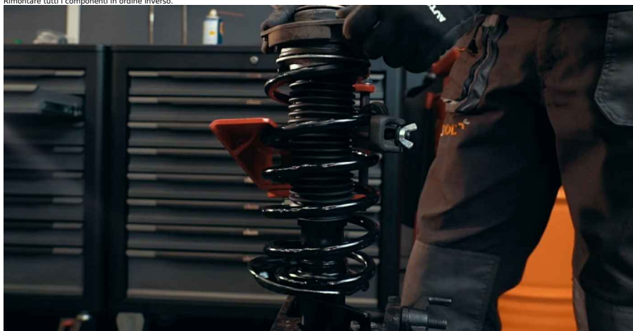
Importante! • Prestare attenzione alla posizione del supporto del puntone per assicurarsi che sia rivolto nella giusta direzione
