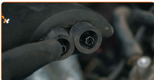
**14** Installare una nuova bobina di accensione nella sede di montaggio
