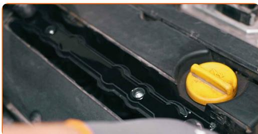
**15** Serrare gli elementi di fissaggio con una chiave dinamometrica alla coppia raccomandata dal produttore
