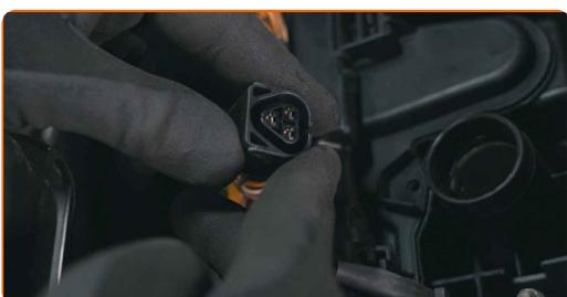
**29** Installare la nuova bobina di accensione nella sede di montaggio
