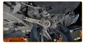
Pulire le sedi di montaggio e preparare nuovi elementi di fissaggio
