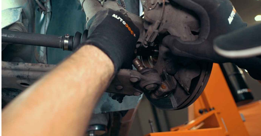
20 Riassemblare tutti i componenti, precedentemente rimossi, in ordine inverso
