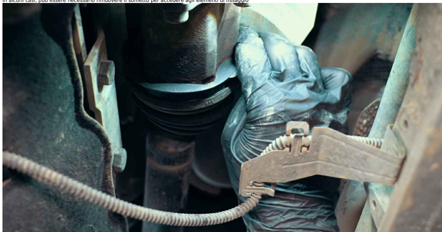
9 In alcuni casi, può essere necessario rimuovere il soffietto per accedere agli elementi di fissaggio
