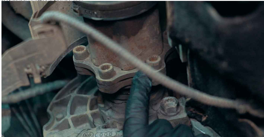
8 Se è presente un montaggio a flangia, svitare i bulloni
