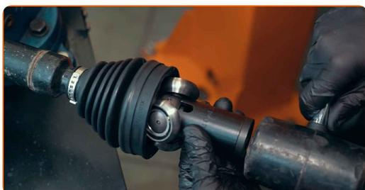
**52** Regolare la posizione della cuffia in modo che gli incavi al suo interno si allineino con i rulli del giunto
