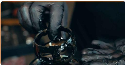
**16** Valutare il grado di usura delle scanalature dell'alloggiamento del giunto omocinetico
