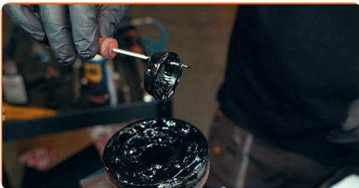
**13** Ruotare la parte interna del giunto omocinetico in diverse direzioni, per quanto possibile, per poi rimuovere tutte le sfere una ad una
