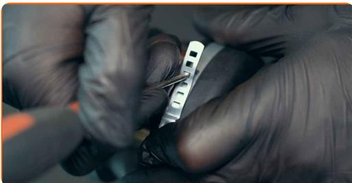
**45** In alternativa, è possibile utilizzare delle pinze a taglio laterale o terminale per serrare il morsetto, usando poi un martello per picchiare il punto in cui è stato serrato
