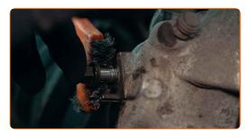
Installare il tubo flessibile del freno. Utilizzare nuove rondelle di tenuta
