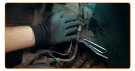
Rimuovere il tubo flessibile del freno dalla propria sede di montaggio con una leggera torsione.
