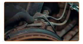
L'ultimo elemento di fissaggio dovrebbe essere quello situato sulla carrozzeria
