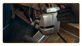
Verificare l'ermeticità del sistema premendo più volte di seguito il pedale del freno
