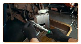
Rimettere il cappuccio protettivo ed effettuare un rabbocco del liquido dei freni nel serbatoio
