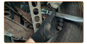
Fissare il tubo flessibile alla carrozzeria dell'auto, prestando attenzione al profilo dell'elemento di fissaggio
