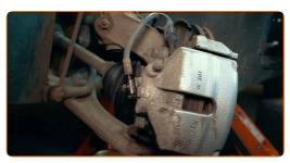
In alternativa, svitare il raccordo del circuito dei freni e svitare il tubo flessibile dalla pinza del freno.
