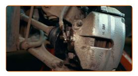
Preparare una vaschetta di scarico e svitare l'elemento di fissaggio
