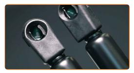
Installare l'ammortizzatore nuovo e fissarlo con le clip
