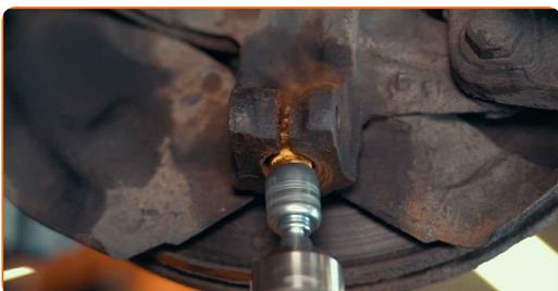
22 Trattare la sede di montaggio del perno sferico con un agente anticorrosione
