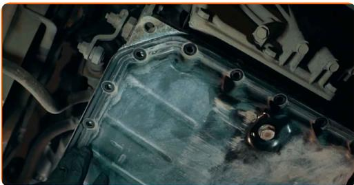
**12** Installare un nuovo tappo di scarico con un anello di tenuta (O-ring).
