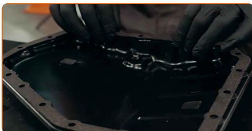
**11** Installare la coppa e stringere i bulloni di fissaggio con la coppia di serraggio indicata dal produttore dell'auto.
