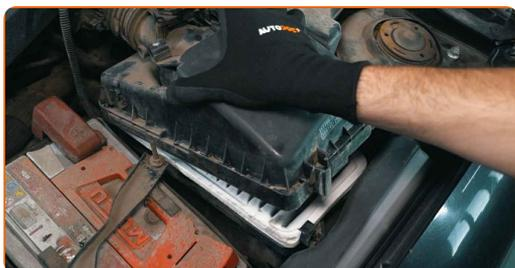
**12** Se il coperchio è fissato tramite delle viti, si rende necessario procedere a svitarle. A tale scopo, si consiglia di utilizzare uno strumento adeguato
