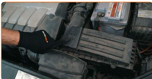
**6** Il coperchio dell'alloggiamento può essere fissato con clip o con viti
